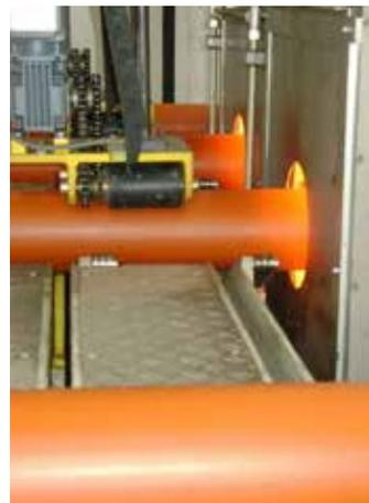
Qui sopra: alcune immagini di tubi in cantiere e durante la fase di termoformatura del bicchiere.
